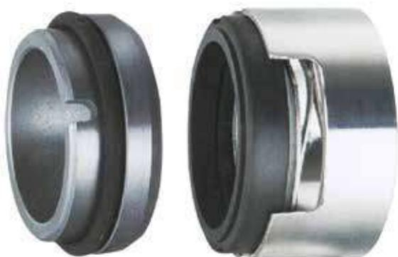
Selo mecânico simples produzido com duas opções de acionamento, sendo o modelo SB-8M por molas tipo "wave" e o SB-84 por múltiplas molas. Sua fixação é feita por parafusos e, com isso, seu funcionamento independe do sentido de rotação do eixo. Indicado para indústria em geral no bombeamento de produtos como óleos, alimentos, água, esgoto etc.
