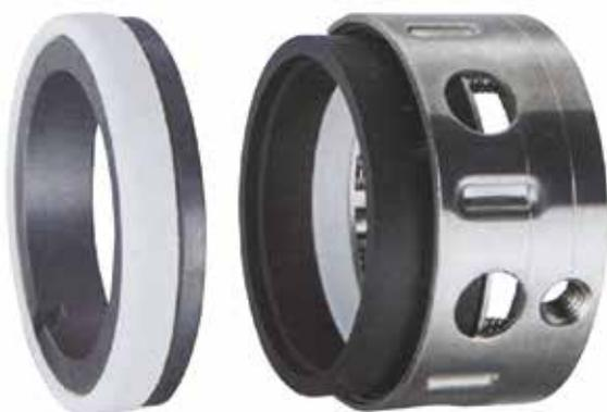
Selo mecânico simples com múltiplas molas e conjunto rotativo montado em estojo que mantém todas as partes em suas posições. As vedações secundárias são em PTFE. É fixado no eixo por parafusos, proporcionando maior segurança e estabilidade no acionamento. Indicado para aplicações mais severas onde não é possível utilizar elastômeros nas vedações. Obs.: Para a opção milimétrica, favor entrar em contato.
