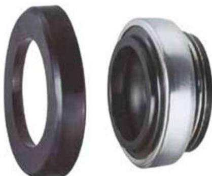
Selo mecânico simples de mola única e vedação no eixo com sistema de fole. Acionamento feito através do fole, independentemente do sentido de rotação. Indicado para uso em bombas com espaço reduzido, curto. Muito utilizado em bombas europeias, nas quais o diâmetro do eixo rotativo é milimétrico. É fornecido montado para instalação rápida e é reparável em campo.
