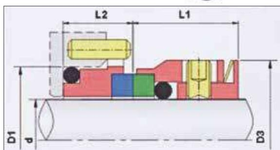
Selo mecânico com acionamento por molas tipo “wave”. Seu comprimento de trabalho é extremamente curto e sua fixação ao eixo é feita por parafusos, promovendo maior segurança e estabilidade no acionamento. Ideal para bombas de lóbulos, onde o eixo duplo e o design compacto da bomba tornam este tipo de vedação a melhor solução. Indicado para indústrias de processamento, alimentos e laticínios.
