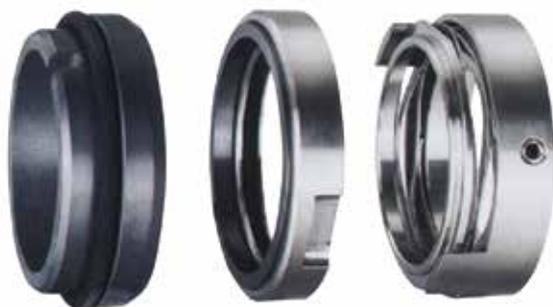
Selo mecânico compacto com acionamento por molas tipo "wave". Seu funcionamento independe do sentido de rotação do eixo. Indicado para indústria química onde o produto bombeado não seja agressivo quimicamente às vedações.
